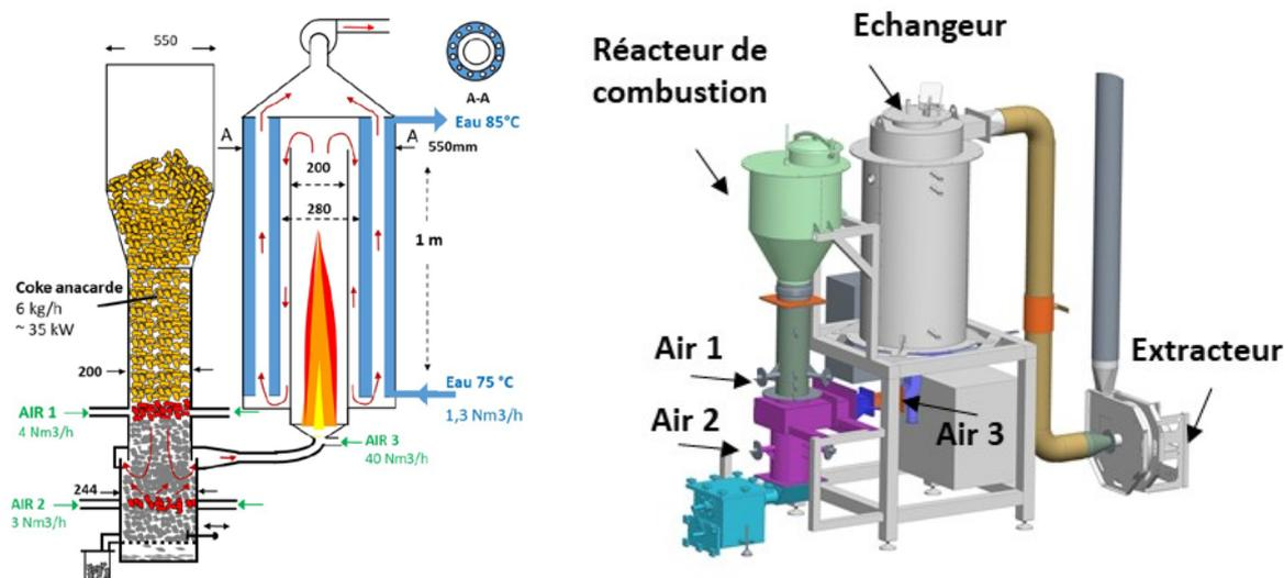
Figure 2 : Schéma de principe et vue 3D de la chaudière.
