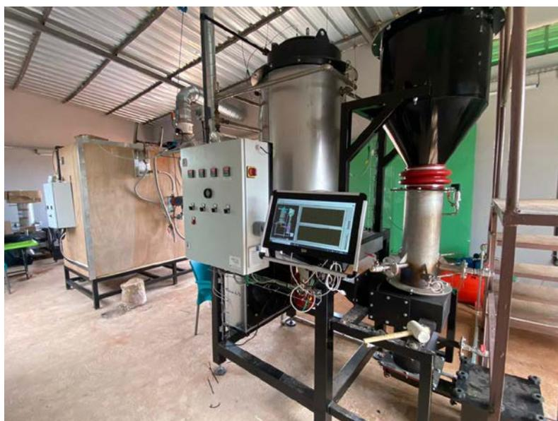
Figure 1 : Photo de la chaudière et séchoir installés chez AgroBurkina
